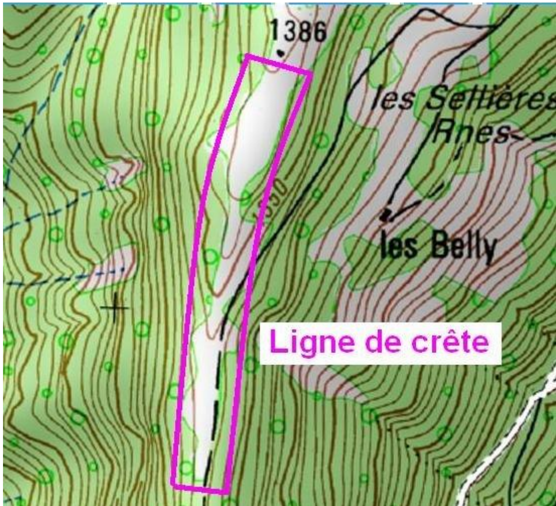
Ligne de crête repérée par la courbure des lignes de niveau
